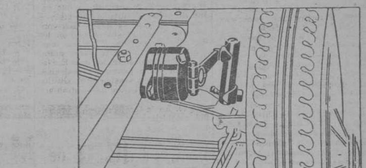
Detalle del amortiguador
