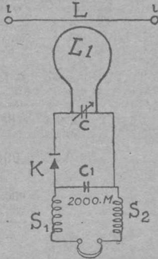
Fig. 2. Esquema para un receptor para onda ultra corta.
