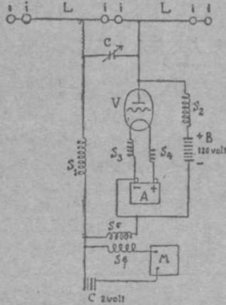
Fig. 1. Esquema para una emisora sencilla para onda corta.
