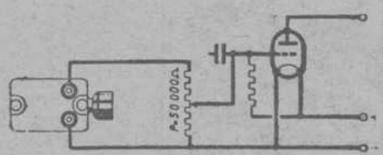
Fig. 3.—Esquema de conexión del fonocaptor al aparato receptor. - Presenta un potenciómetro de 50.000 ohms para la regulación del volumen sonoro
