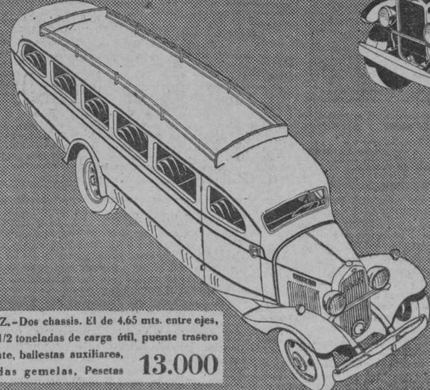
BLITZ.—Dos chasis. El de 4,65 mts. entre ejes, 3-3.1/2 toneladas de carga útil, puente trasero flotante, balistas auxiliares, Ruedas gemelas, Pesetas 13.000
