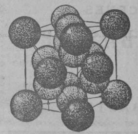
Fig. 2. La más diminuta porción de diamante, lo que se llama "cristal elemental", está formado por átomos de carbono que ocupan los vértices y los centros de las caras de un cubo. En lo interior de este cubo hay cuatro átomos de carbono formando un tetraedro. En un gramo de diamante que pese sólo un miligramo, hay nada menos que seis millones de billones de tales cubos.
