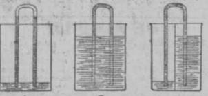
aquí que la altura a que queda la columna mercurial del tubo, sirva para medir la presión atmosférica, que es precisamente la misión del barómetro.
