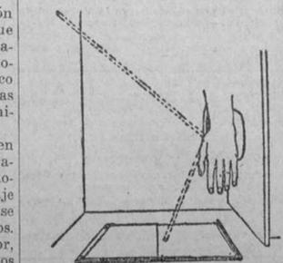
que reciba el rayo y lo refleje en el techo según se indica con líneas de puntos en el dibujo. Dispuestas así las cosas es muy fácil contar las pulsaciones. Se apoya la muñeca en el borde del tazón y el rayo de luz del techo registrará los movimientos del pulso con movimientos breves y bruscos.
