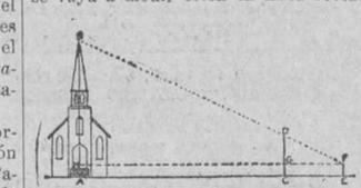
Los extremos inferiores de todas las piezas deben estar en línea recta horizontal. Colocado el palo corto en su debido sitio se mide la distancia de su base á la del objeto y determinadas estas dimensiones se obtiene la siguiente proporción: la altura B H es á la altura D G como la distancia H F es á la distancia G F ó la altura B H es igual á
