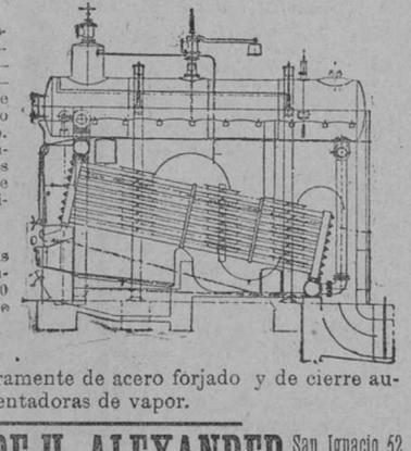
Facilidad del transporte y del montaje.—Gran seguridad y facilidad en la limpieza.—Gran superficie caldeadora y acopio de agua y vapor seco.—Vaporización garantizada de 9 á 10 litros de agua por kilo de carbón neto consumido.
