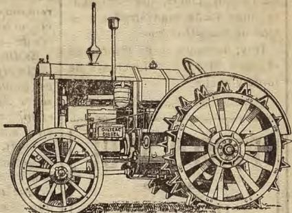
Tractor «OILTRAC» de ruedas, legítimos DIESEL, construcción alemana, con arranque eléctrico en frío, de 36 y 50 HP modelos 1935
