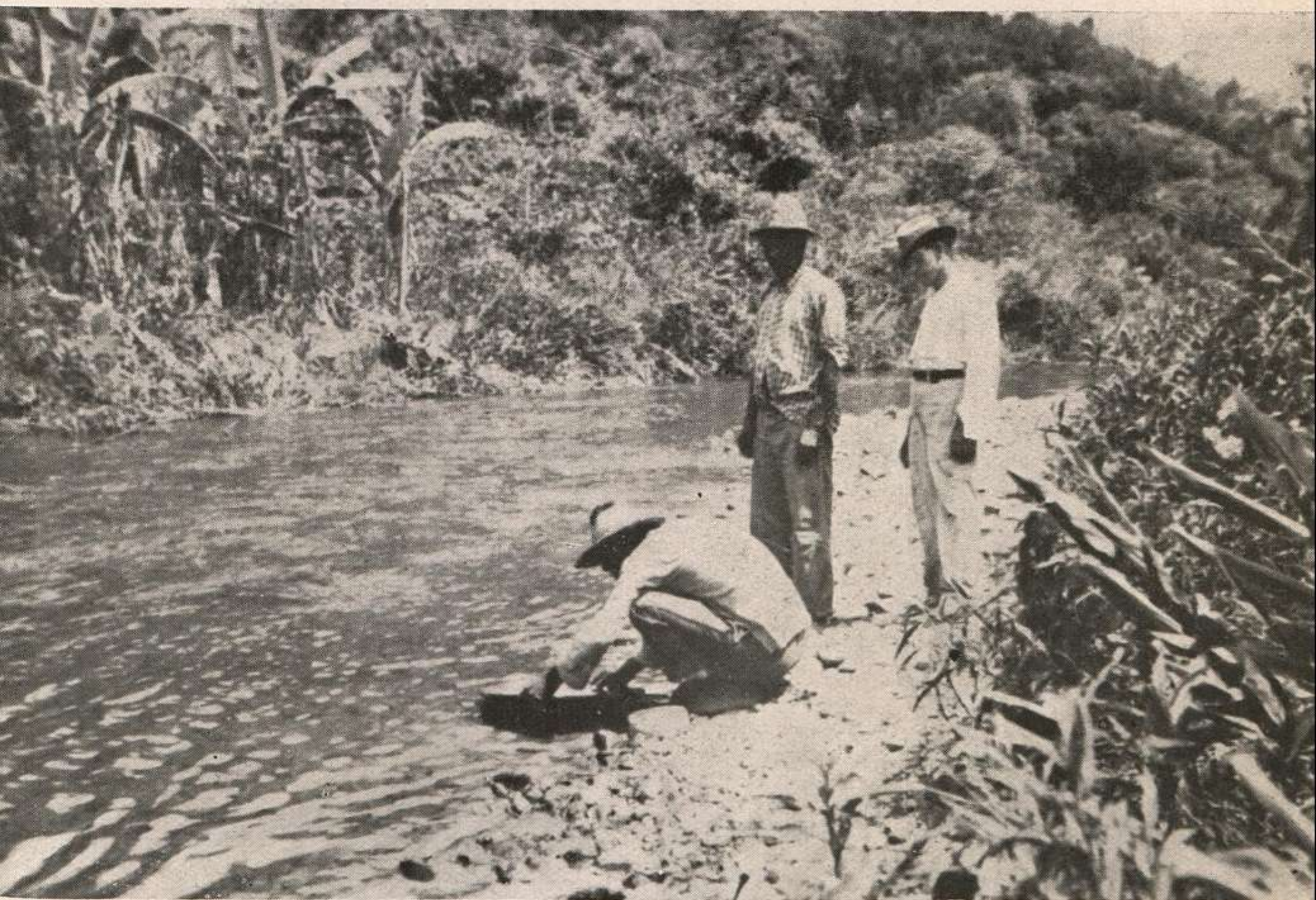
Lavagem do cascalho aurifero no Yporanga, afluente da margem direita do rio Ribeira
