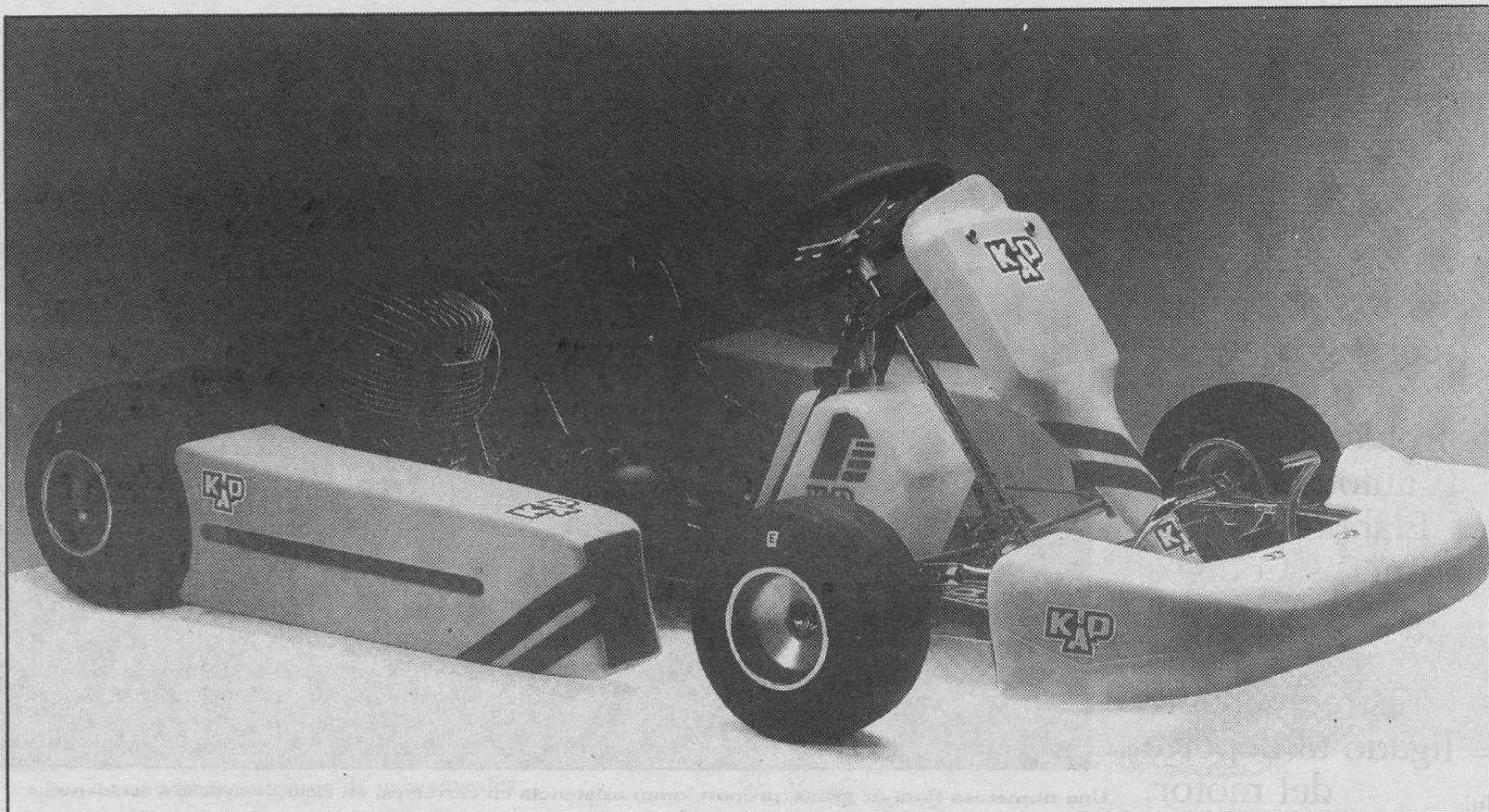
Línea de penetración aerodinámica y bastidor robusto de simple cuna, en tubo de acero cromo-molibdeno
