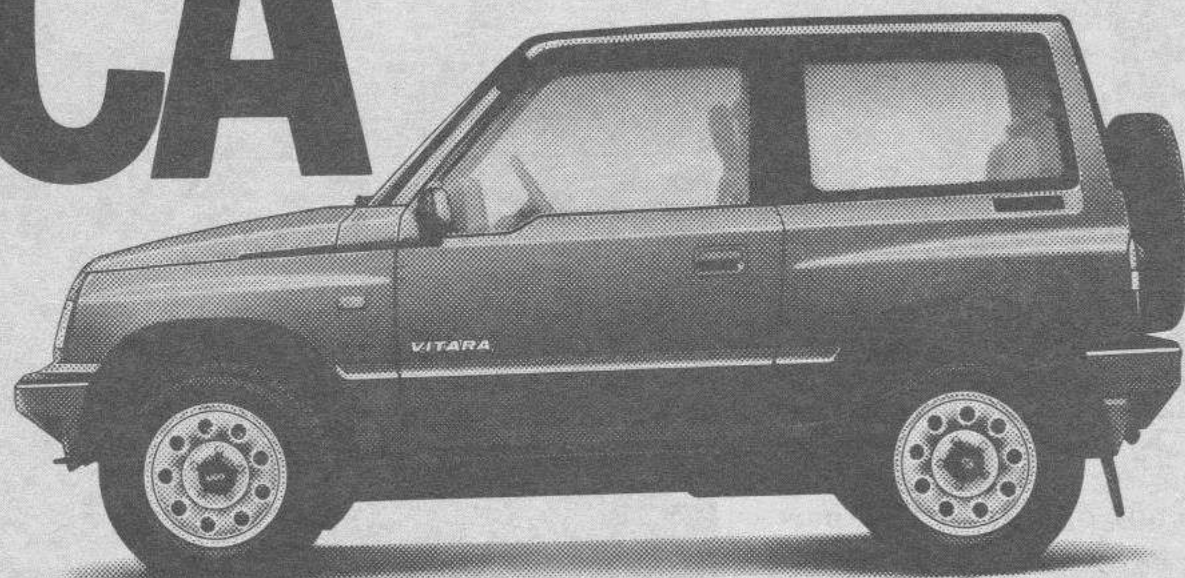
SUZUKI VITARA CARBURACION. 1590 cc. 74 cv. Carburadores de doble cuerpo. Sistema de rueda libre opcional. Amplio equipamiento.
