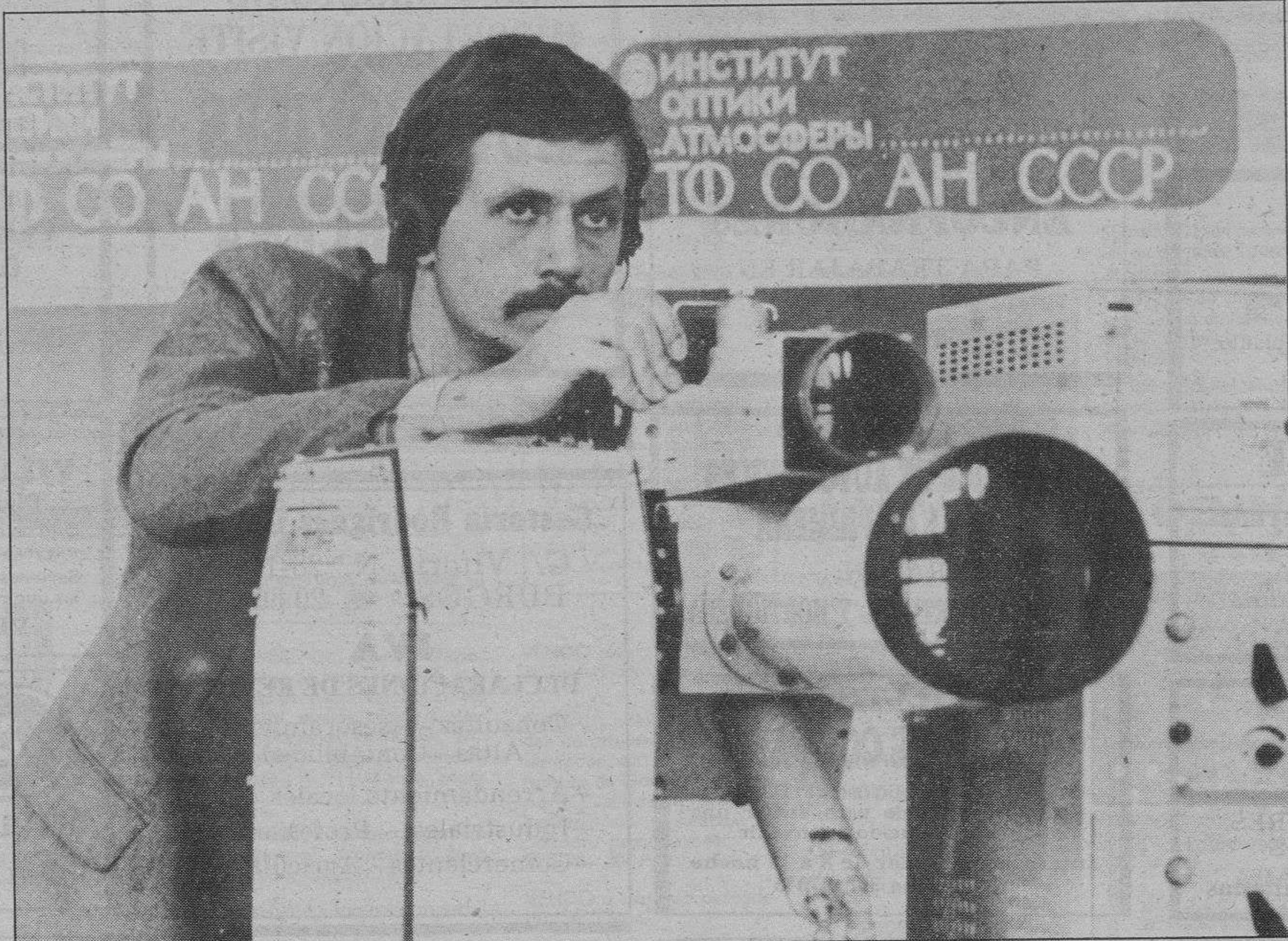
El radar «Mokrel-2», está destinado a medir desde un avión, las profundidades marinas. En el aparato se utiliza el laser «MIAN-M», igual en que los faros de navegación
