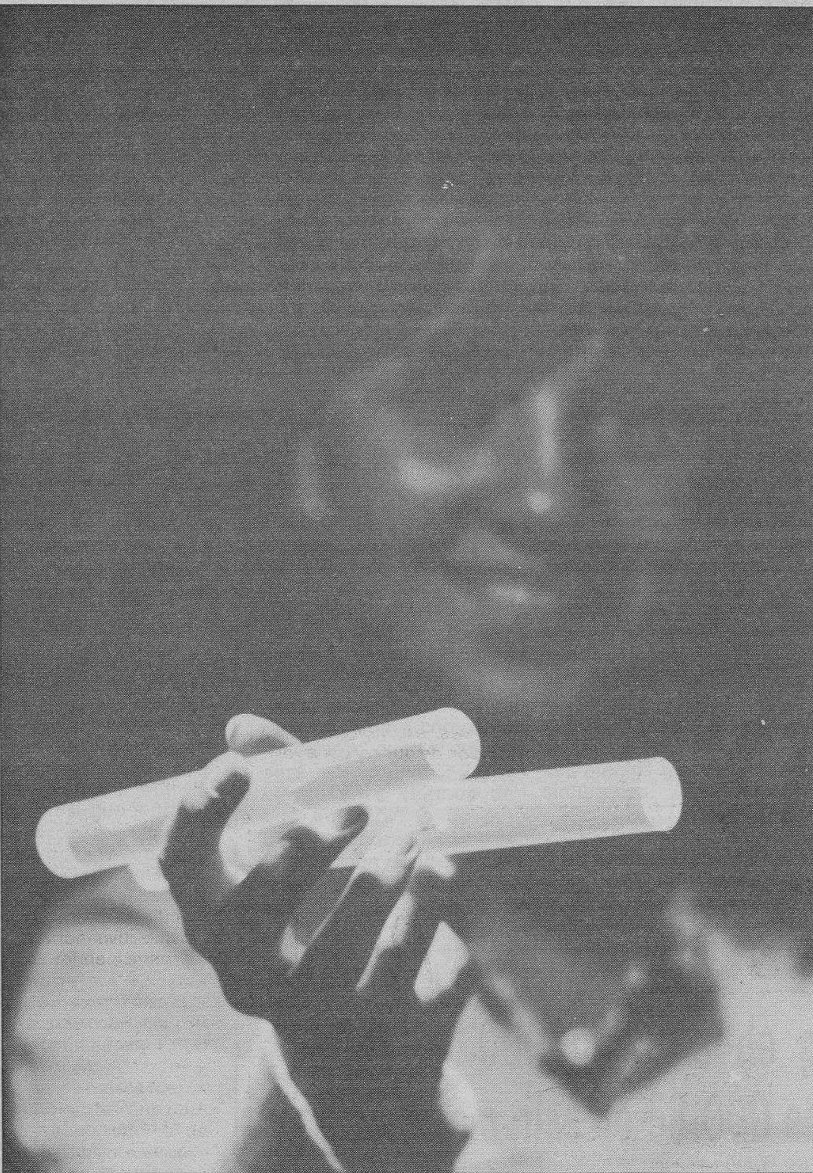
PLASTICO DE CONVERGENCIA LUMINOSA. — El consorcio químico Bayer AG, de Leverkusen (República Federal de Alemania), ha conseguido obtener un nuevo material sintético, denominado LISA, que posee la propiedad de hacer converger incluso emisiones de luz muy débiles para proyectarlas después en las aristas. LISA reveló su importancia para la aplicación técnica, muy diversa, cuando Bayer logró desarrollar además nuevos tipos de plásticos transparentes y nuevas lacas fluorescentes con muy alta intensidad luminosa y resistencia a la acción de la luz y a las inclemencias del tiempo. LISA cuenta además con la ventaja de que las planchas confeccionadas con el nuevo producto sintético pueden ser fresadas por la parte de atrás o impresas, resultando por ello especialmente aptas para la fabricación de rótulos de calles, numeración de edificios o superficies destinadas a la publicidad comercial o rótulos de comercios, lo cual además resulta posible en muchos colores.
