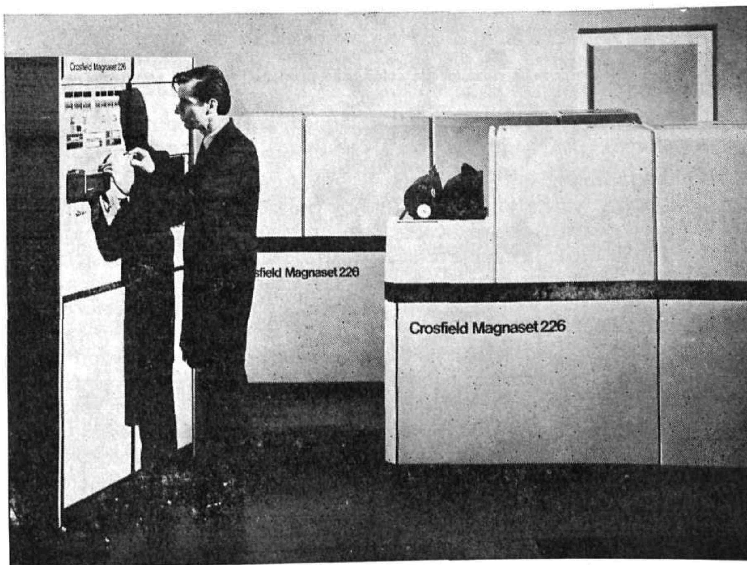
El equipo «Magnaset 226», de asombrosas posibilidades para la fotocomposición; él puede realizar una producción hasta de 1.000.000 de caracteres por hora.
