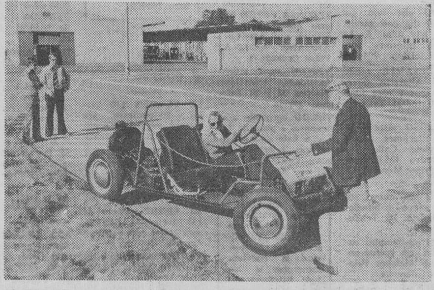
En el parque experimental de tráfico de la ciudad alemana de Bremen ha comenzado a prestar servicio para los aprendices de conductores un nuevo vehículo. Se trata del «esqueleto» de un coche, es decir, el chasis sin la carrocería. No hay peligro de abolladuras y los principiantes del volante aprenden a aparcar y a maniobrar con mayor precisión ya que su visión del espacio es así más amplia — (Foto FIEL)
