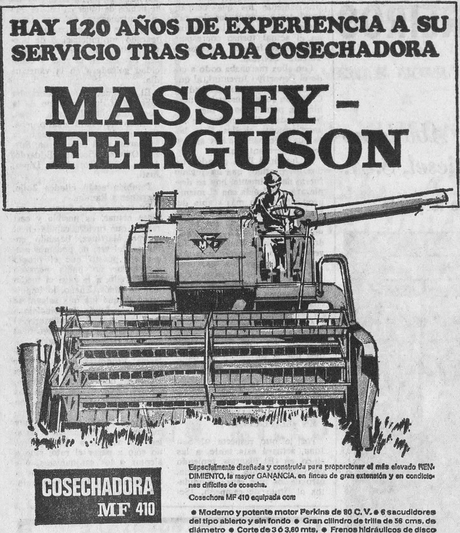
o Dirección hidráulica o Tanque para grano de 2.360 litros Mandos totalmente hidráulicos.
