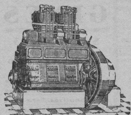
A cuatro tiempos. Simple efecto. Arranque en frío. Consumo mínimo. Manejo fácil. Se construyen en potencias desde cuatro caballos. Absoluta seguridad en el servicio. Garantías de todas clases.
