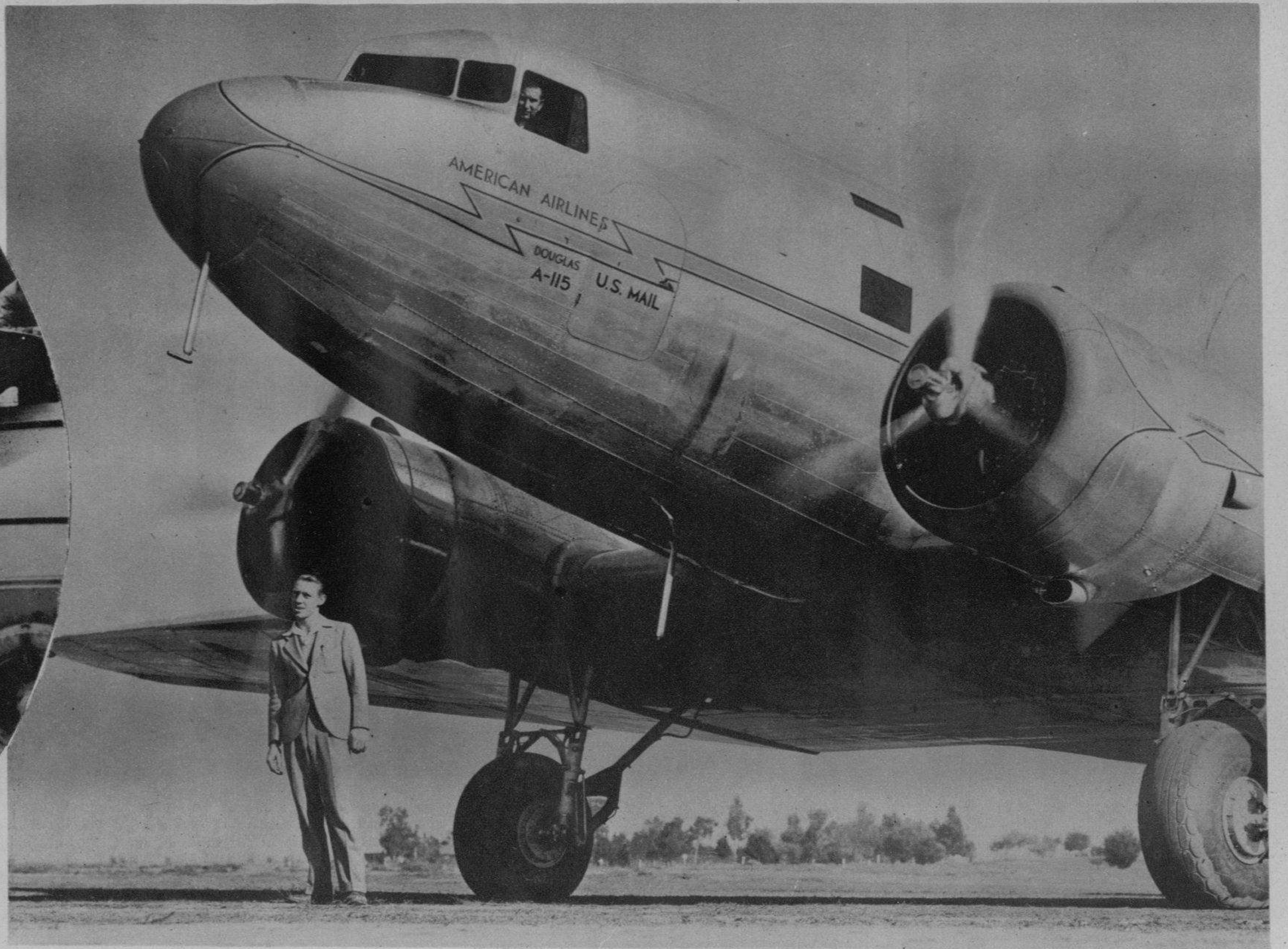
UN GRAN avión para transportar hasta 12 toneladas de peso, está preparado en Santa Mónica para hacer su primer viaje. Tiene capacidad para 24 pasajeros; es todo de metal y está provisto de dos motores de 930 caballos de fuerza cada uno, que pueden desarrollar una velocidad de 215 millas por hora. La marca es Douglas (Foto Wide)
