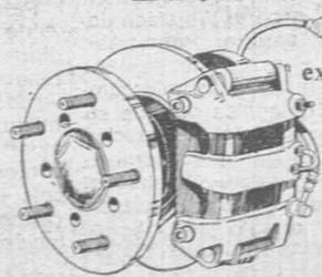
Doble circuito independiente de expansión hidráulica, servo-freno, y frenos de disco en las ruedas delanteras.
