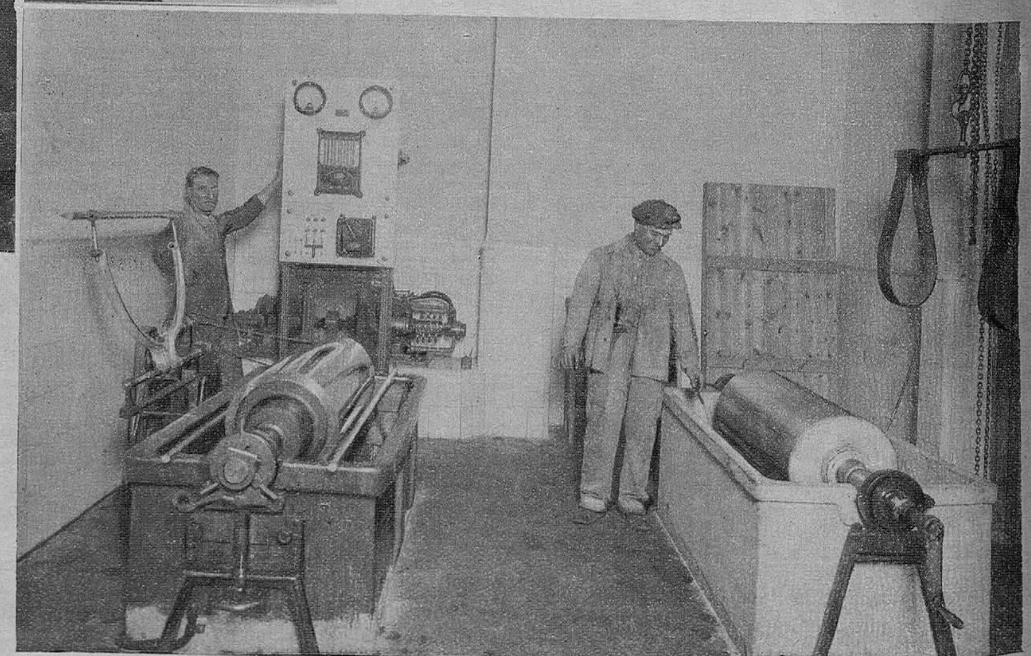
Aparato para borrar los cilindros, después de impreso el periódico.
