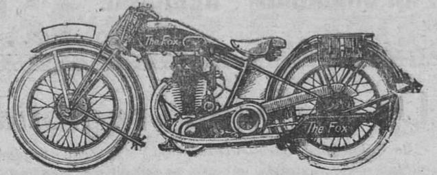
Modelos de 175, 250 y 350.—Cuatro tiempos, válvulas en cabeza y alumbrado eléctrico.
