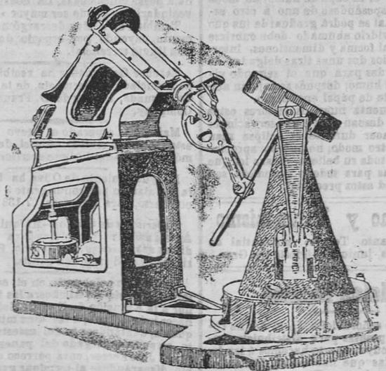
Modelo de un siderostato.—Este aparato es muy usado en los trabajos recientes de espectroscopia celeste. El instrumento consta de un espejo plateado, matemáticamente plano y de fabricación costosísima, que aparece colocado sobre el pie de la derecha. El espejo es movido por un aparato de relojería, de suerte que su movimiento sigue al del astro, y el espejo envía siempre una imagen pura y limpia del Sol al punto ocupado por el espectroscopio.
