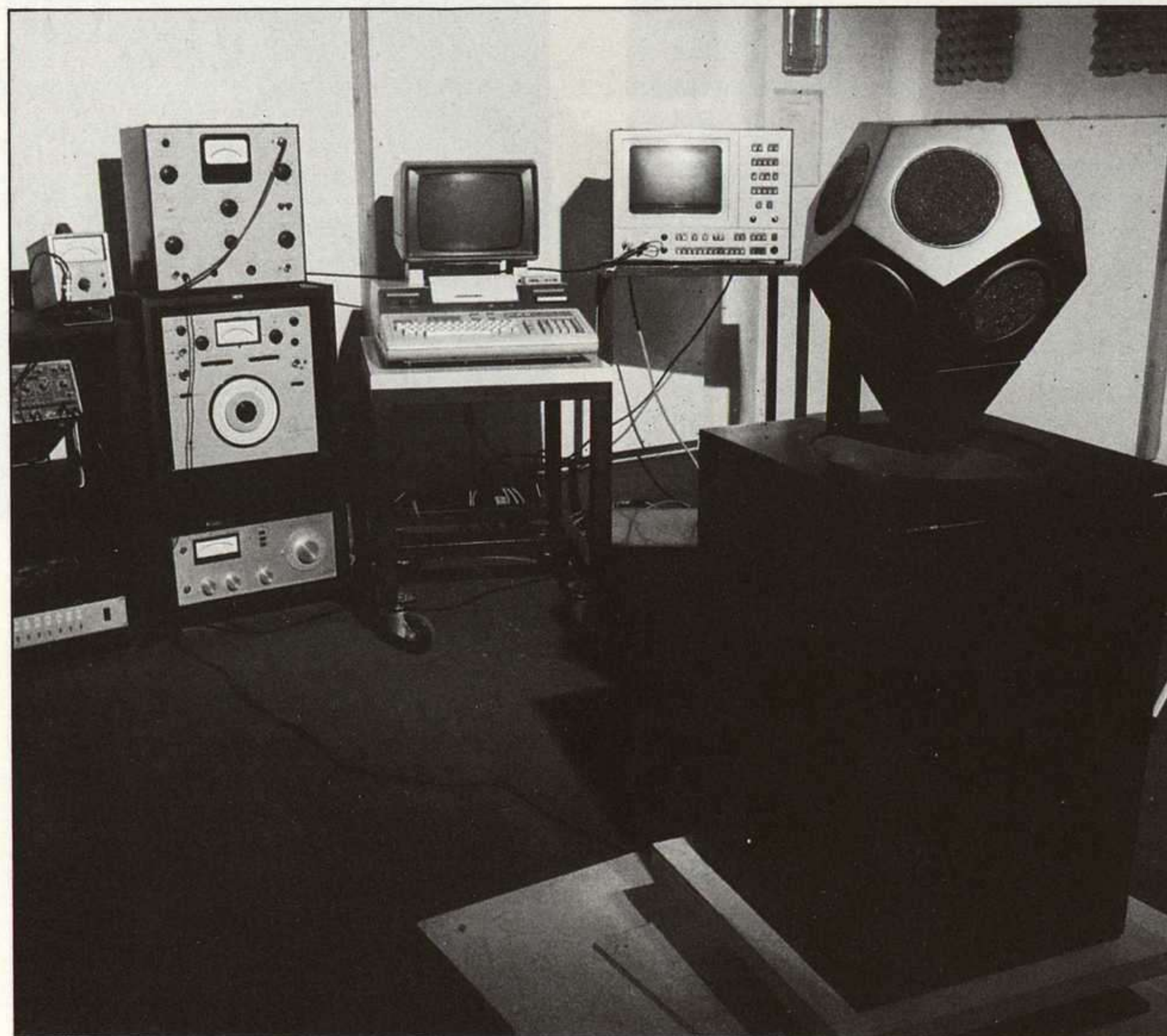
Verificación pantallas acústicas omnidireccionales.
