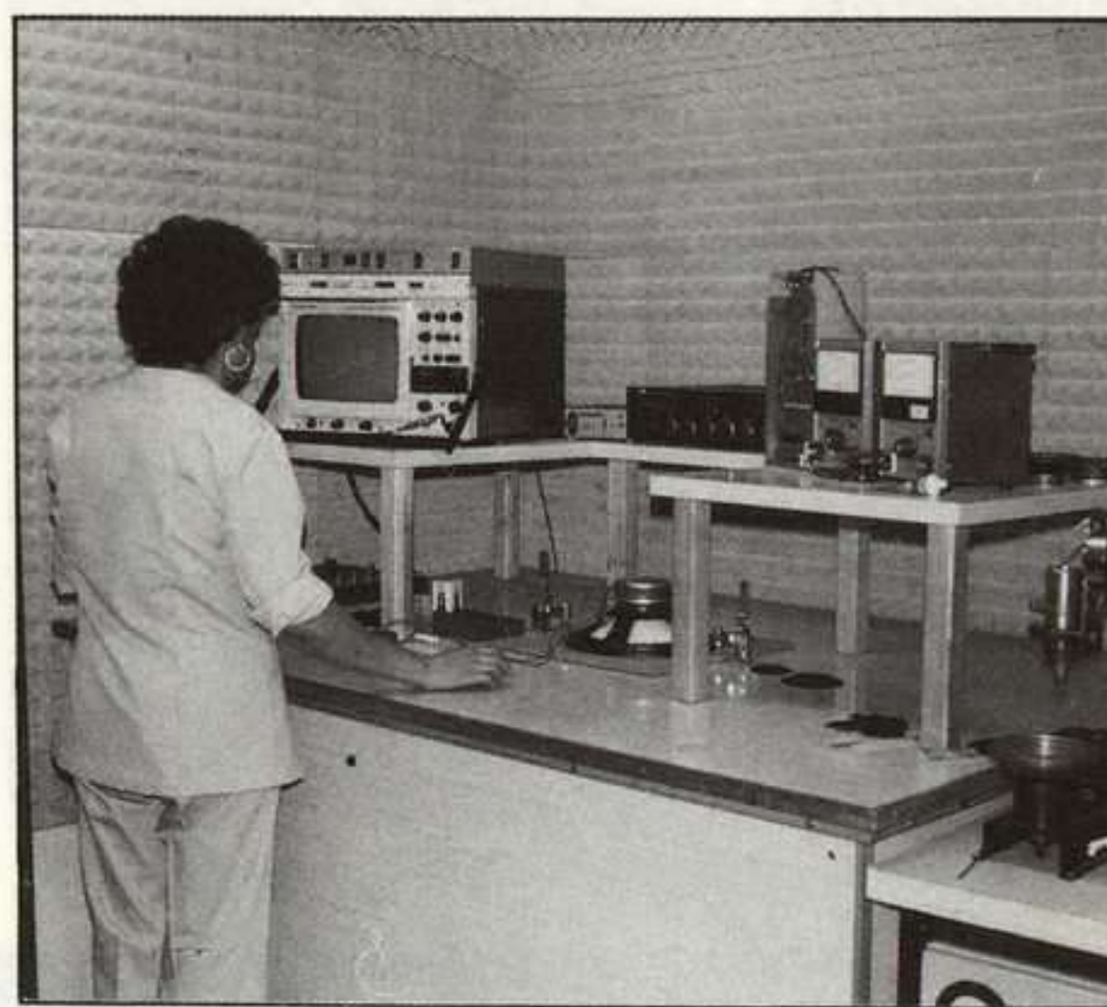
Verificación unitaria de altavoces.
