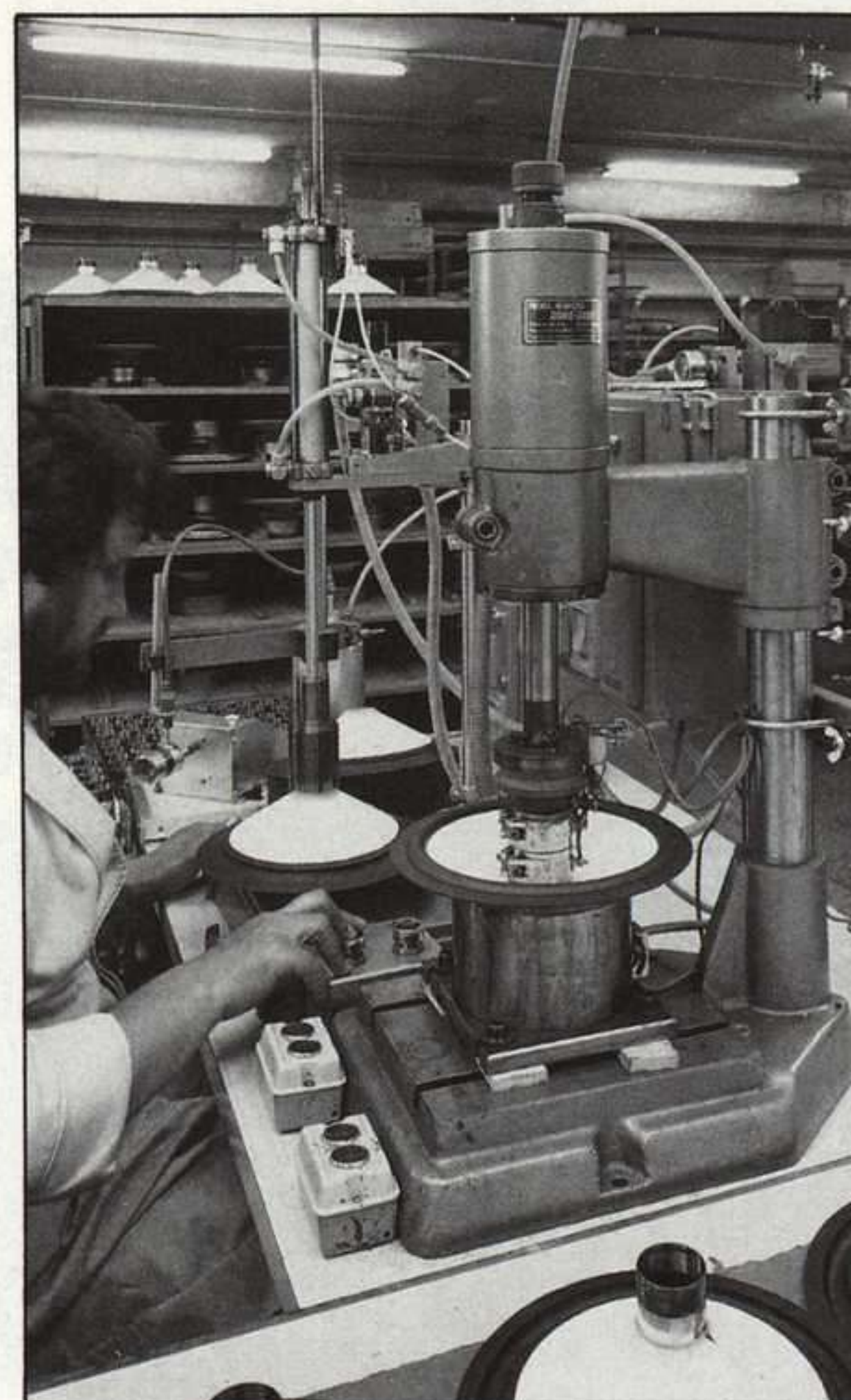
Remachado de la bobina móvil a la membrana
