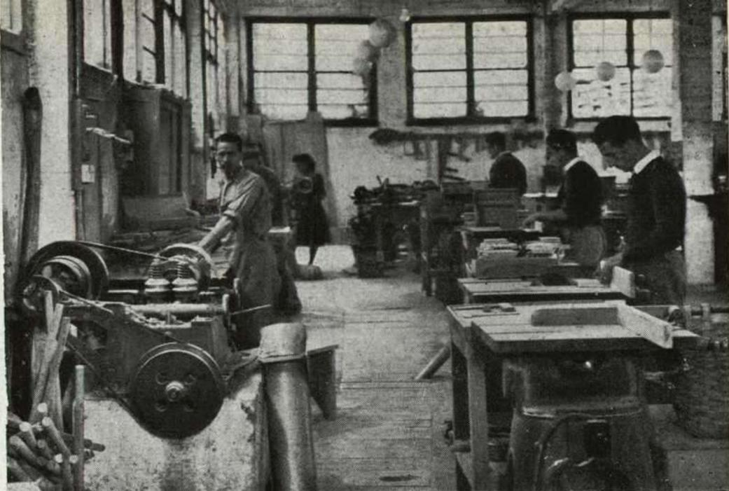
Primera fase de la fabricación. Sala de máquinas en donde se preparan las piezas para el chasis, con maderas especiales previamente tratadas para evitar alteraciones por cambios de temperatura
