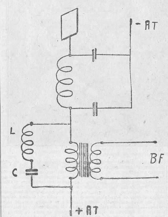
Acuencia aguda (tanto más perceptibles cuanto más sensibles sean los aparatos receptores) debidos a la interferencia de ondas portadoras de longitud de onda muy próxima. Para conseguir la eliminación basta montar en paralelo sobre el primario del transformador de baja frecuencia la bobina L y el condensador C...
