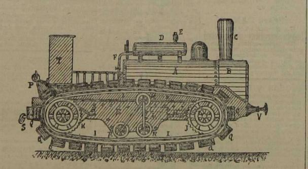
Figura 17.—Curioso modelo de locomotora, construido por la casa Armstrong y adoptado por el ejército inglés para el arrastre de las grandes piezas de artillería
