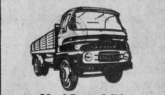
5 1/2 - 6 Tn. 107 CV. 6 cilindros Diesel
