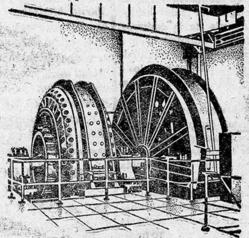
se halla en Alemania occidental, construida por la AEG y DEMAG. 7,5 m. de diámetro tiene su volante; 5 m. el motor de una potencia máxima de 10.000 HP.
