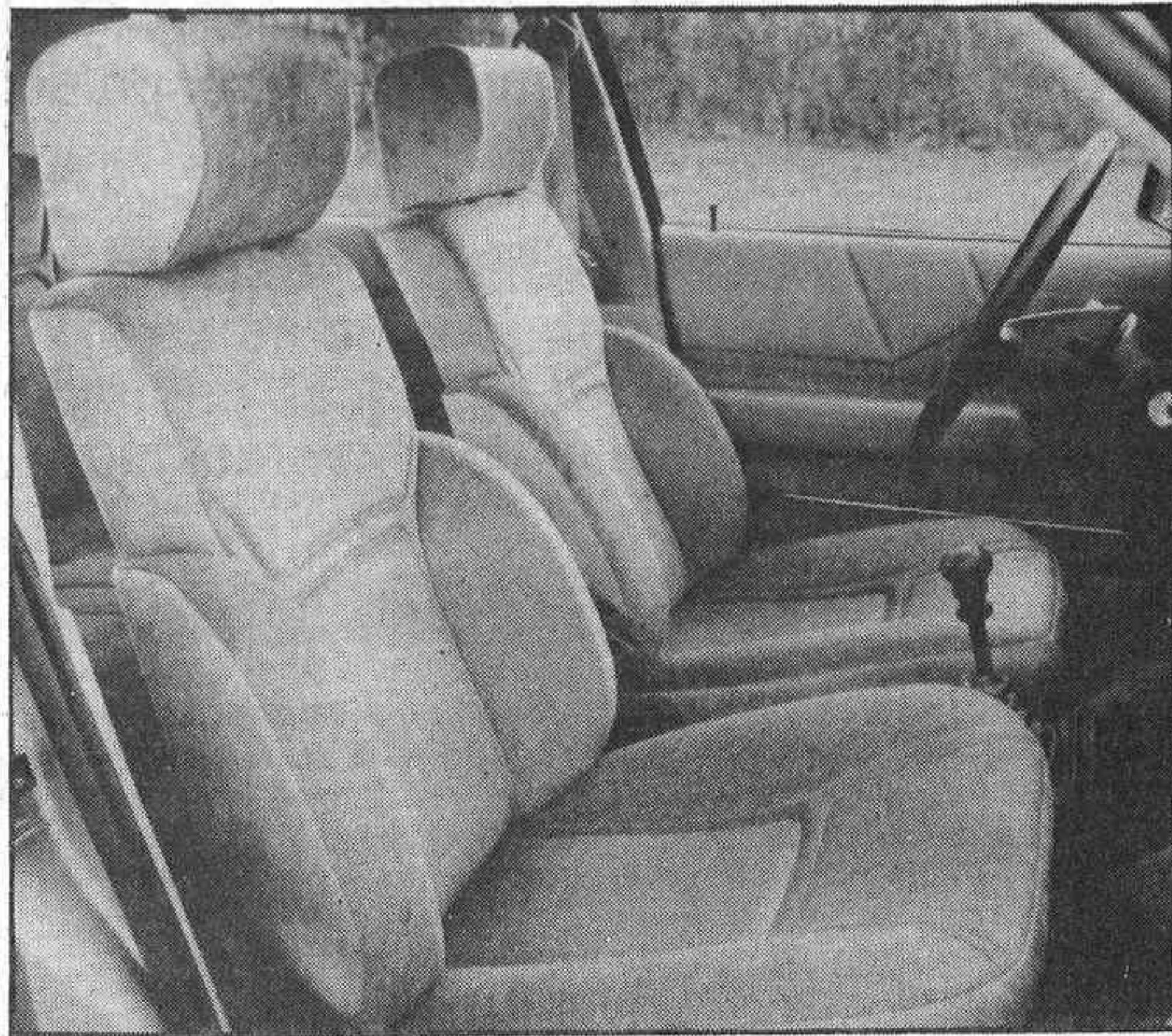
Los asientos delanteros, «monogufa» petalizados, están tapizados en paño al igual que el guarnecido de puertas y los asientos posteriores, que en este modelo es abatible por partes asimétricas.
