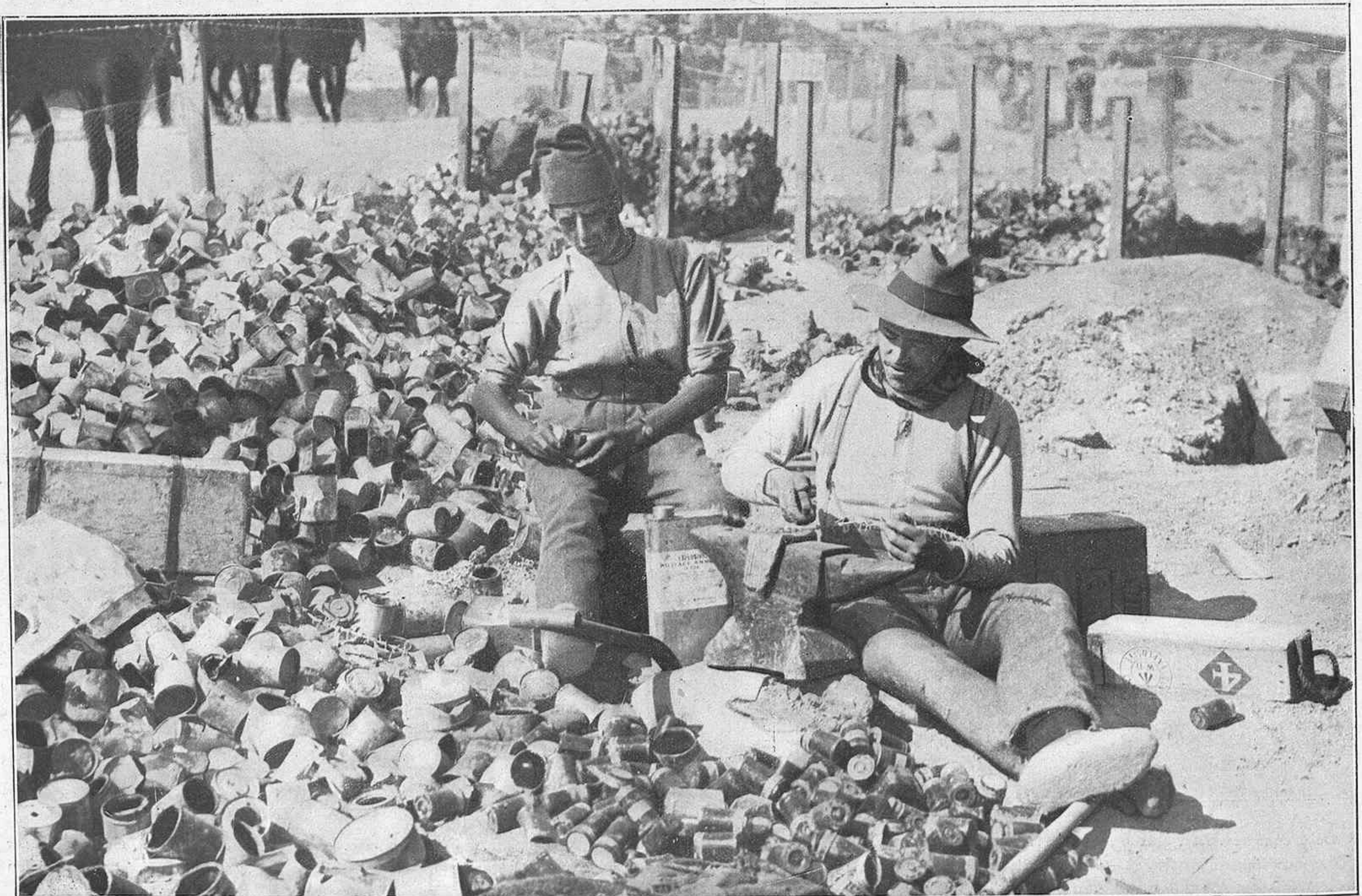
En los Dardanelos. - Soldados aliados fabricando bombas de mano, para las cuales utilizan viejas latas de conservas y otros receptáculos análogos, fragmentos de proyectiles turcos y alambres cogidos en las alambradas de las posiciones enemigas. (De fotografía de Carlos Trampus.)
