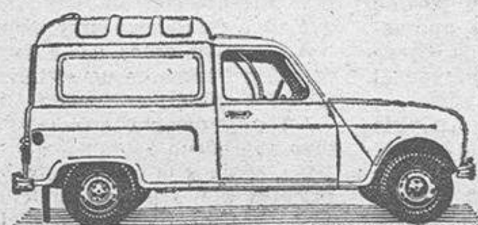
Renault 4 furgoneta Carga 350 kg. Altura útil 1,160 m.
