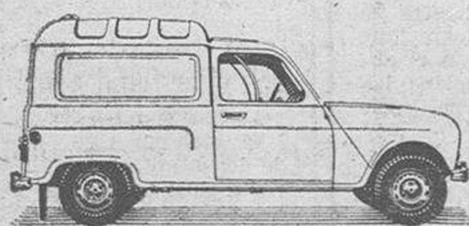
Renault 4 furgoneta Carga 350 kg. Altura útil 1,150 m.
