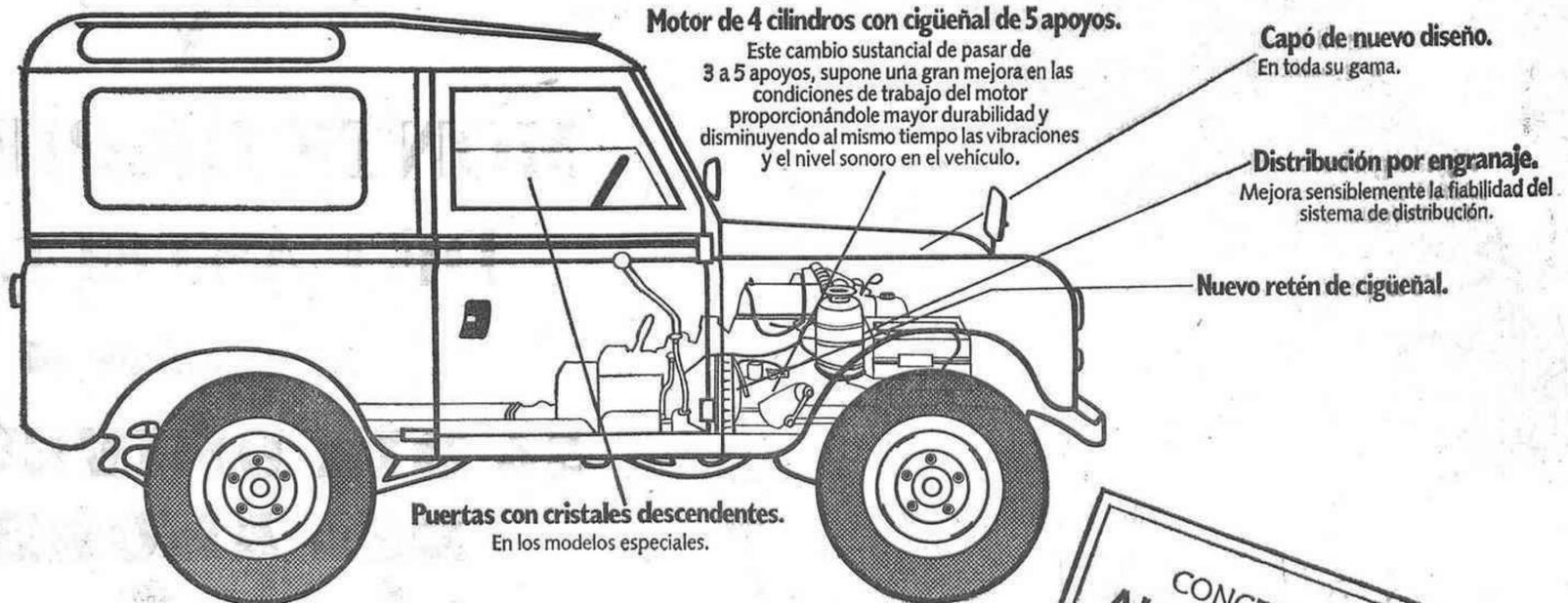
**Motor de 4 cilindros con cigüeñal de 5 apoyos.**
