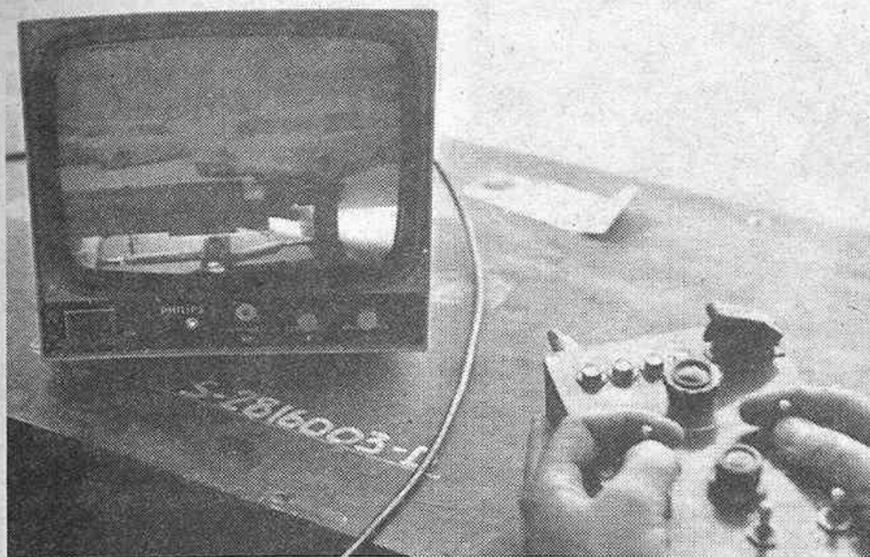
Es guiado por control remoto y a través de un monitor de televisión
