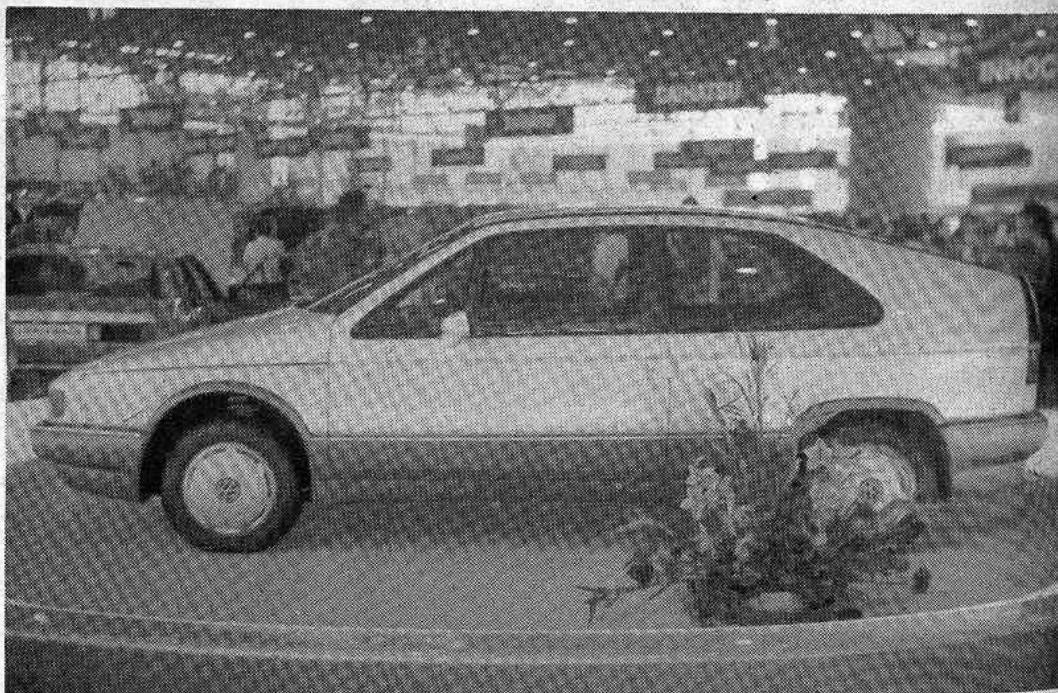
Proyecto elaborado por Volkswagen para el Ministerio de Industria alemán del coche del futuro. Velocidad: 170 km/h, 3,01 litros/Gas-oil y 620 kilos de peso.
