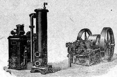
Motor y Gasógeno (Gas pobre)
