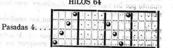
Este dibujo se puede tejer en 8 perchadas, repasando los 64 hilos, según indique la operación de extraer el de poner en máquina.
