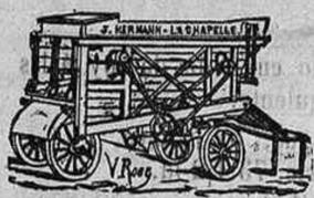
Máquina á vapor y bomba para riego.
