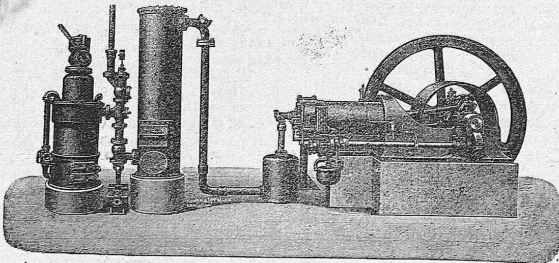
Única casa constructora de los legítimos motores OTTO en combinación con aparatos para gas pobre; sistema por aspiración sin caldera, sin gasómetro.
