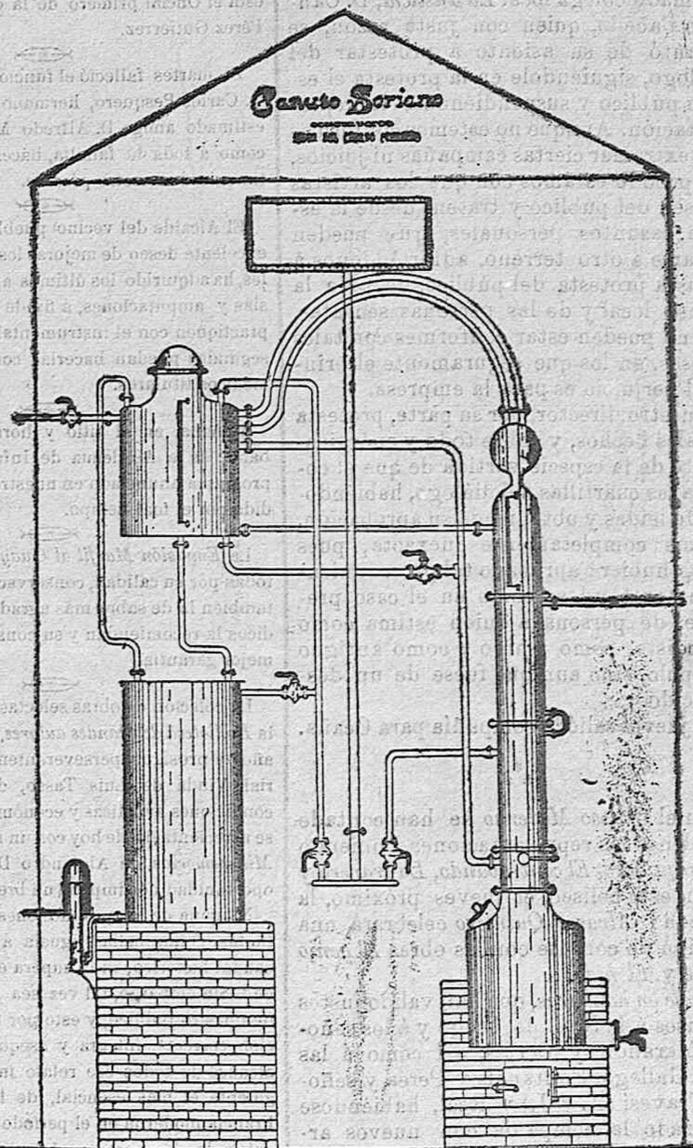
Aparato SISTEMA GIESVER para la quema de orujos, maiz, viños picados, produciendo alcoholes en su rectificación de 95 á 96 grados. Precio del mismo, de 650 litros de cubida 2.750 pesetas, montado y garantizada su buena marcha y la buena clase de alcohol de su producción.
