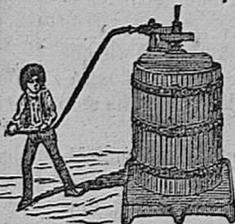
Prensa Hércules, para uvas sistema de palanca múltiple reforzada. Pisadoras, Separadoras y estrujadoras de uva.
