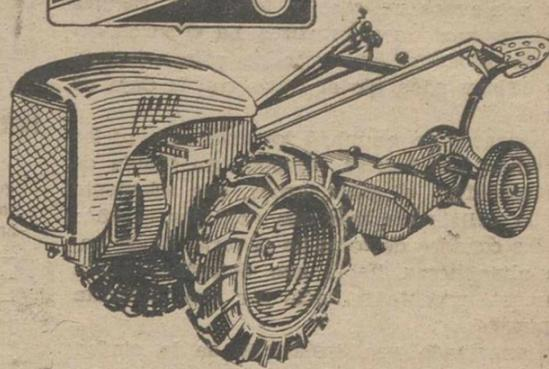
CON MOTOR DIESEL DE 7 HP
