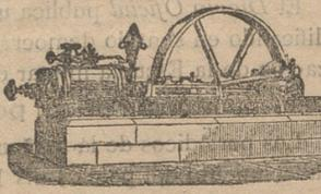
Máquina de vapor fija horizontal
