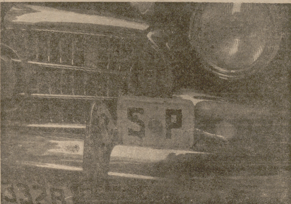
Luz blanca sobre la placa de S. P. delantera de un autotaxi. Antirreglamentaria.
