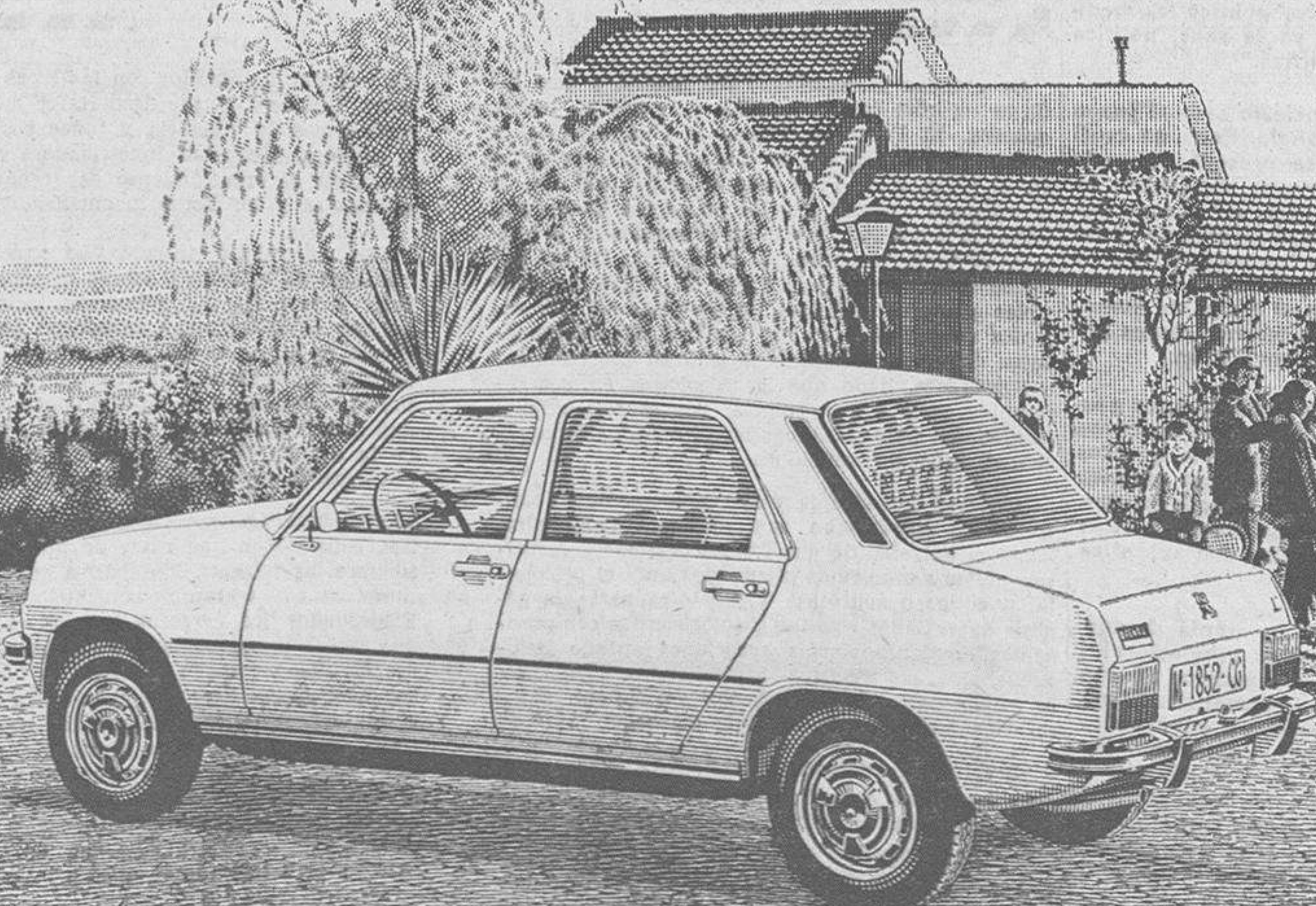
Motor Renault 1.037 cm 3 Tracción delantera. Suspensión por barras de torsión. Cuatro puertas.
