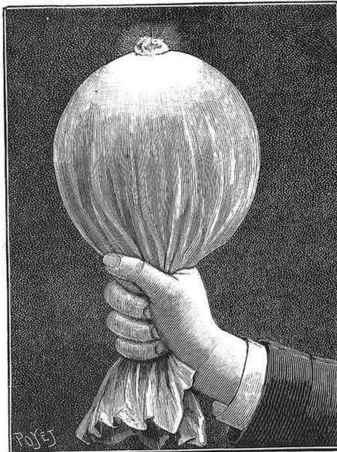
Fig. 1. - Brasa incandescente puesta sobre un pañuelo de batista que envuelve una bola de cobre. - El pañuelo no se quema
