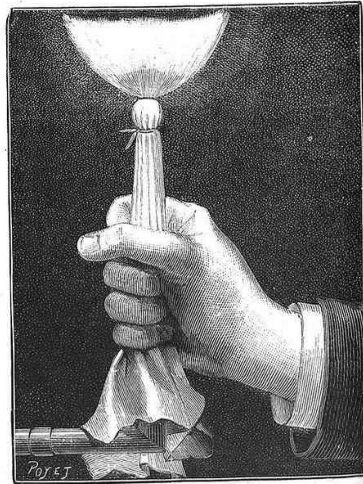
Fig. 2. - Mechero de gas envuelto en un pañuelo de batista bien estirado. - La llama sale por encima del pañuelo sin quemarlo
