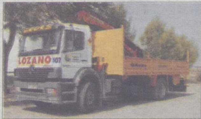
CAMION GRUA 45 T.N.
