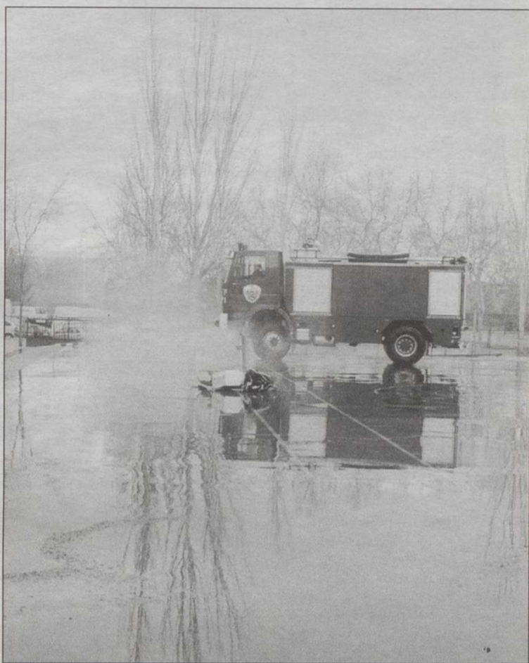
El vehículo puede lanzar agua a 30 metros de distancia y apagar rastrojos sin la intervención humana.
