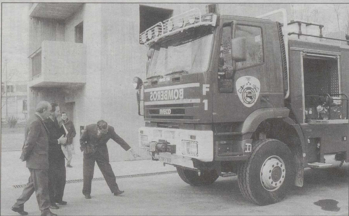
El sistema de protección forma una cortina de agua alrededor del vehículo y las ruedas.
