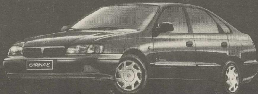
• Parrilla cromada • Motor 16 válvulas • 106 CV • Dirección asistida • Elevalunas eléctrico
